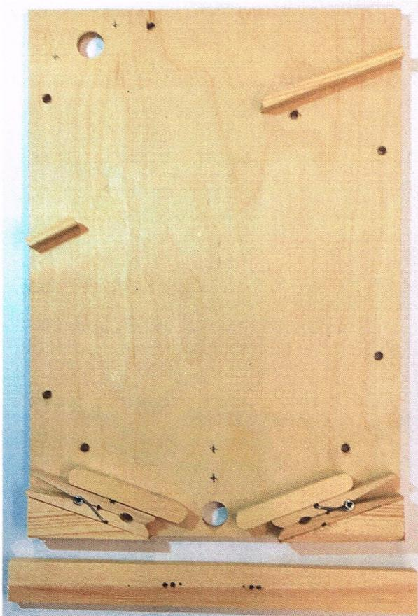
Gebohrte Bodenplatte mit provisorisch aufgelegten Bauteilen und eingezeichneten LED-Bohrungen.
