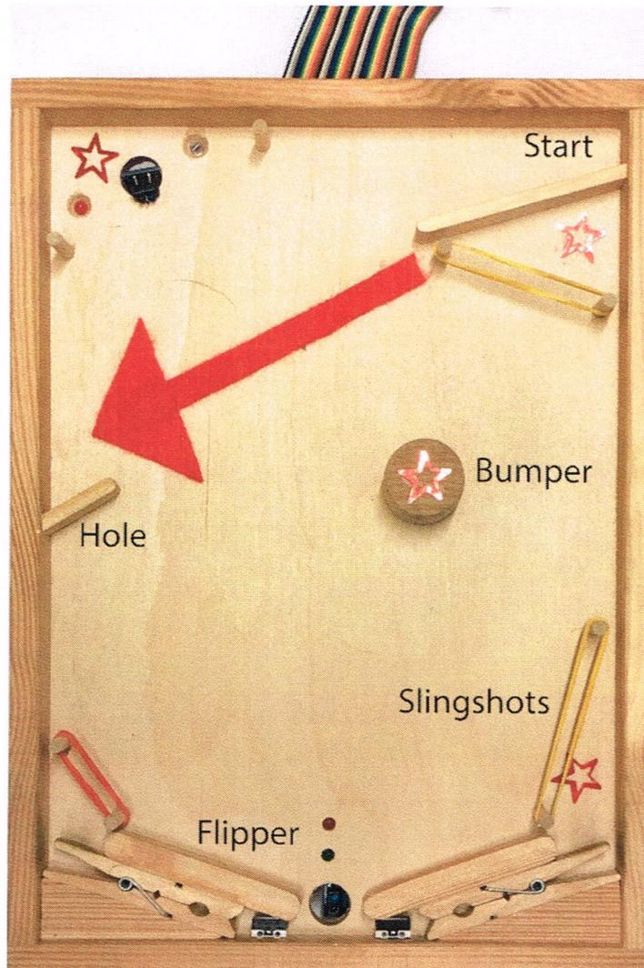
In der Grundausstattung verfügt unser Flipper über eine Startrampe für die Kugel, ein Hole als Ziel, diverse Slingshots, um die Kugel abprallen zu lassen sowie Flipper, um die Kugel selbst zu spielen. Die Flipper sind aufgesetzt auf Holzwäscheklammern, wodurch die mechanische Konstruktion recht einfach ist.
