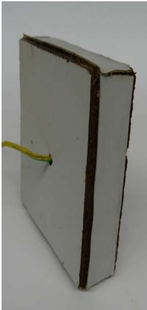
Spanplatte mit Umleimer
