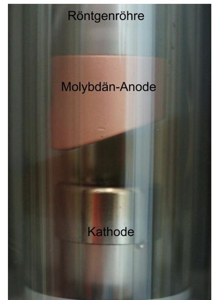
Abb. 3: Röntgenröhre mit Molybdän-Anode
