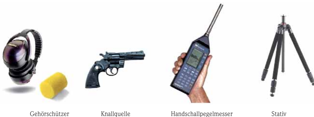
Abb. 36: Equipment zur Durchführung von Nachhallzeitmessungen.
