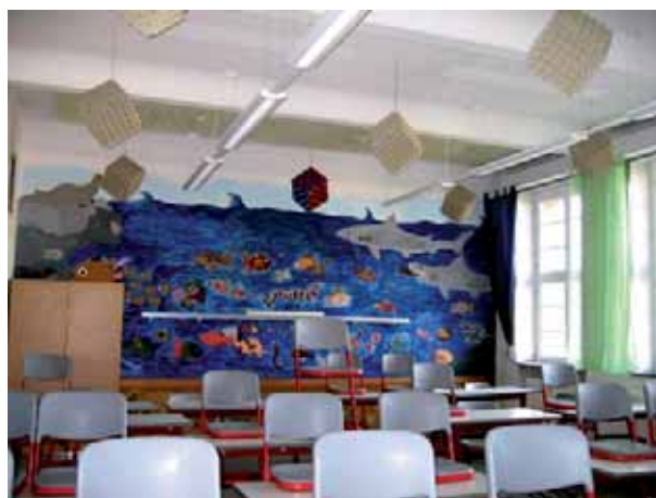
Abb. 30: Klassenzimmer in Eigenarbeit akustisch gestaltet, V=220\text{ m}^3 , Decke glatt gestrichen.
