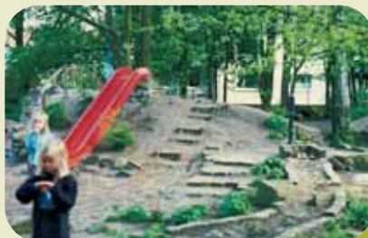
Ausreichend befestigte Materialien für Aufstiege und Wege, Steine im Aufprallbereich neben der Rutsche
