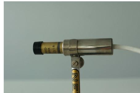
Abb. 3: Geiger-Müller-Zählrohr mit Anschlusskabel
