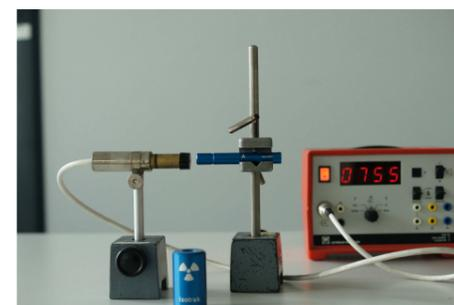
Abb. 4: Zählrohr und Gerät bei der Vermessung eines Am-241 Strahlers.
